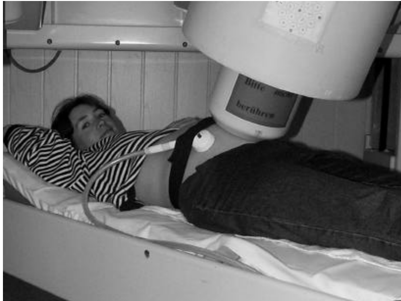
Abbildung 1: 31-Kanal-Biomagnetometer in Messposition innerhalb der Messkammer und liegende Probandin, Applikation des akustischen Stimulus über ein Schlauch-Duschkopfsystem direkt auf die mütterliche Bauchdecke
